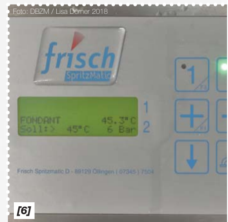
[4-6] Jedes Modul verfügt über eine eigene Steuerungseinheit. Die Steuerung für Aprikotur und Fondant erlaubt das genaue Einstellen der Parameter Temperatur und Druck sowie des WIS Water Injection Systems.
