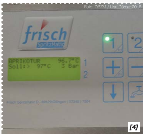
[4-6] Jedes Modul verfügt über eine eigene Steuerungseinheit. Die Steuerung für Aprikotur und Fondant erlaubt das genaue Einstellen der Parameter Temperatur und Druck sowie des WIS Water Injection Systems.
