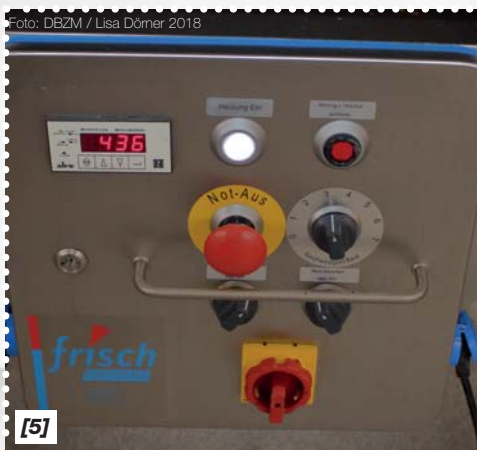
[4-6] Jedes Modul verfügt über eine eigene Steuerungseinheit. Die Steuerung für Aprikotur und Fondant erlaubt das genaue Einstellen der Parameter Temperatur und Druck sowie des WIS Water Injection Systems.
