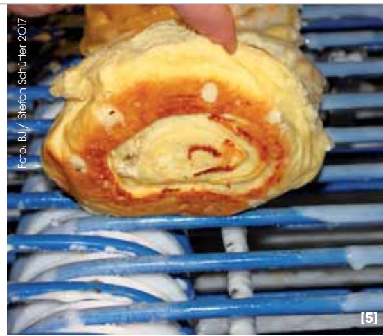
[4] Wenn man durch den laufenden Fondantfilm leicht hindurchsehen kann, ist der Schleierkasten auf die richtige Dosierung eingestellt. [5] Abstreifer säubern die Transportbänder der Anlage bei jedem Umlauf. So bleiben die Böden der zu veredelnden Gebäcke immer sauber und trocken. [6] Ist der erste Korb voll, läuft der Korbtransport vor und bringt den zweiten Korb in Position, sodass die zweite Gebäckcharge des laufenden Takts hineinlaufen kann.
