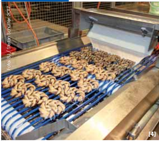
[4] Wenn man durch den laufenden Fondantfilm leicht hindurchsehen kann, ist der Schleierkasten auf die richtige Dosierung eingestellt. [5] Abstreifer säubern die Transportbänder der Anlage bei jedem Umlauf. So bleiben die Böden der zu veredelnden Gebäcke immer sauber und trocken. [6] Ist der erste Korb voll, läuft der Korbtransport vor und bringt den zweiten Korb in Position, sodass die zweite Gebäckcharge des laufenden Takts hineinlaufen kann.
