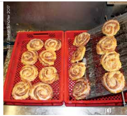
[4] Wenn man durch den laufenden Fondantfilm leicht hindurchsehen kann, ist der Schleierkasten auf die richtige Dosierung eingestellt. [5] Abstreifer säubern die Transportbänder der Anlage bei jedem Umlauf. So bleiben die Böden der zu veredelnden Gebäcke immer sauber und trocken. [6] Ist der erste Korb voll, läuft der Korbtransport vor und bringt den zweiten Korb in Position, sodass die zweite Gebäckcharge des laufenden Takts hineinlaufen kann.
