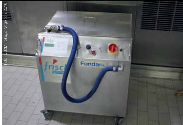
Alle Module sind fahrbar. Sie sind überall in der Backstube einsetzbar und die Reinigung des Arbeitsplatzes und der Geräte im Spülraum wird deutlich erleichtert.
